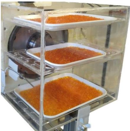
*Entfeuchtungskammer für Tieftemperaturanwendungen*
