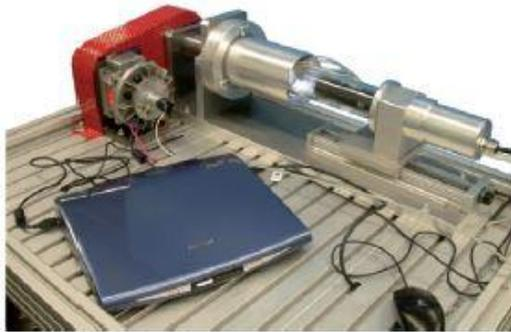
*Prüfstand für visuelle Strömungsuntersuchungen*
