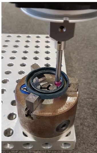
Vermessung einer Dichtringgeometrie
