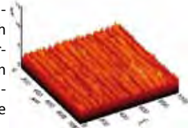
Topografie einer Wellenoberfläche
