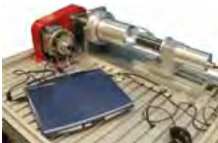
Optischer Prüfstand zur Untersuchung der Strömung unter der Dichtkante
