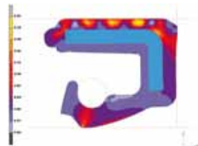
FE Simulation an einem Radialwellendichtring
