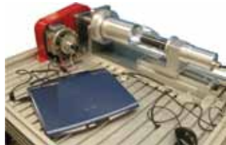
Optischer Prüfstand zur Untersuchung der Strömung unter der Dichtkante
