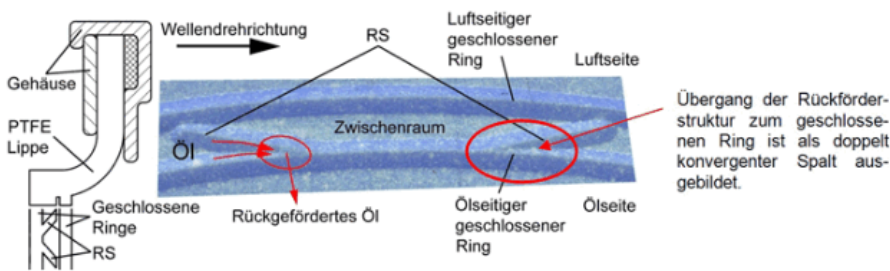
Bild 3: Querschnitt und 3D-Aufnahme eines PTFE-Dichtrings mit optimierten Rückförderstrukturen für beide Drehrichtungen der Welle
