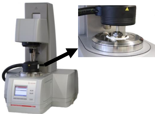
Rheometer MCR 302 mit Temperierhaube (links) und Kegel-Platte Versuchsaufbau (rechts)
