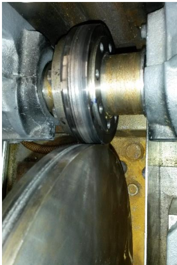
Kontaktsituation am 1:10-Rollenprüfstand
