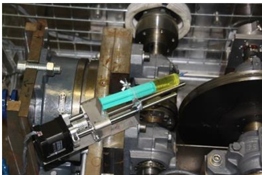
Spritzenpumpe zum Einbringen zähflüssiger Zwischenmedien
